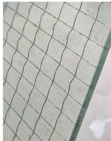
STÄNKSKYDD Trådglass återbrukad från Varvsstaden. Monteras med spegellist i aluminium
